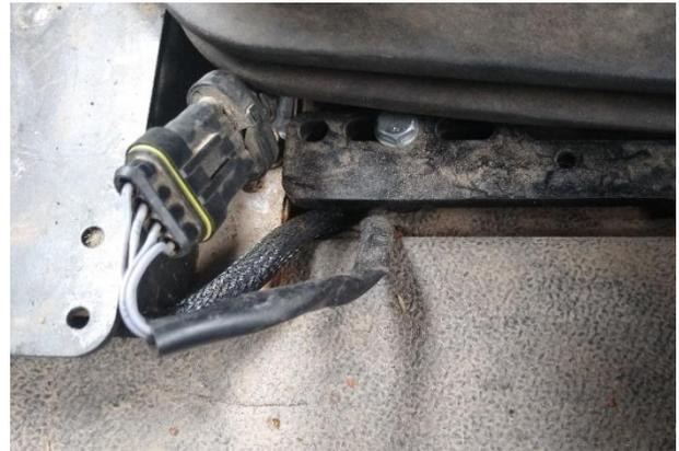
FIGURE 37 EXISTING TRACTOR OPERATOR PRESENCE SWITCH CONNECTOR
